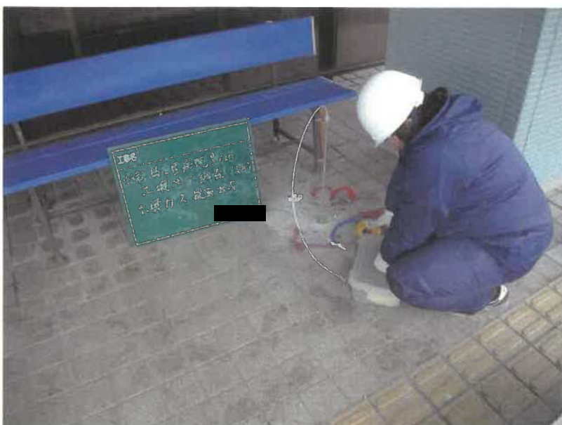
負圧をかけて 土壤ガスの採取
